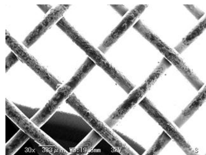
サンプルⅠ 層厚 = \sim 50 \mu\text{m} B doped 水素終端表面
